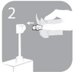
2 Insérer l'extrémité dans le tonomètre en alignant le trait avec le zéro.
